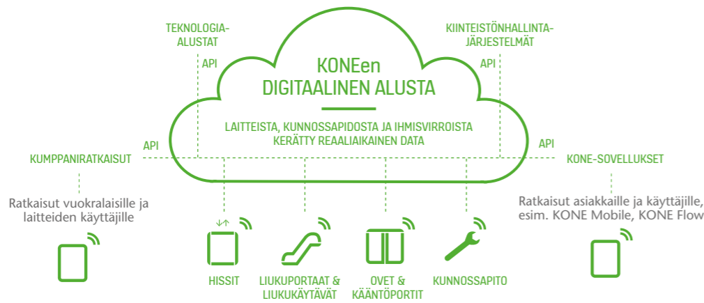
KONEen digitaalinen alusta yhdistää ihmiset – asiakkaat, loppukäyttäjät ja henkilöstön – laitteet ja datan varmasti ja turvallisesti. Laitteet liitetään pilveen ja kumppaneiden ratkaisuihin ohjelmointirajapintojen (API) kautta, joten ne on helppo päivittää ja modernisoida.
